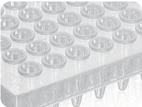
Выступы по краям лунок позволяют предотвратить перекрестное загрязнение и обеспечить лучшую герметизацию
